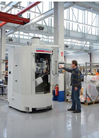
Maschine vom Typ „Sphero“ für die Feinstbearbeitung von Endoprothesen in der Endausrüstung
