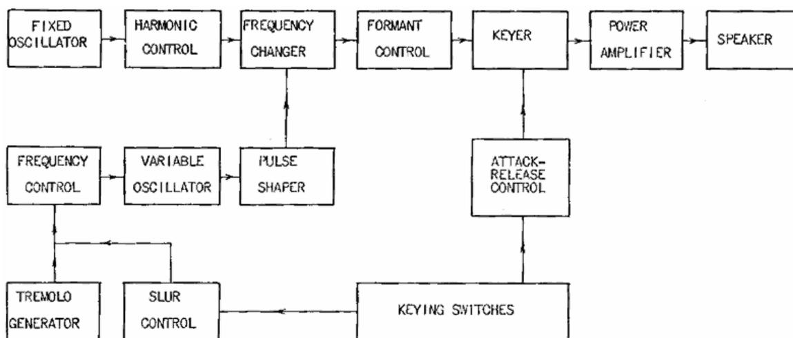
FIGURE 1 - BLOCK DIAGRAM OF ONE VOICE CHANNEL
