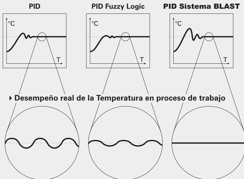
La alta precisión alcanzada por el Controlador PID Sistema BLAST en la Estufa hace que la misma tenga un comportamiento óptimo.
