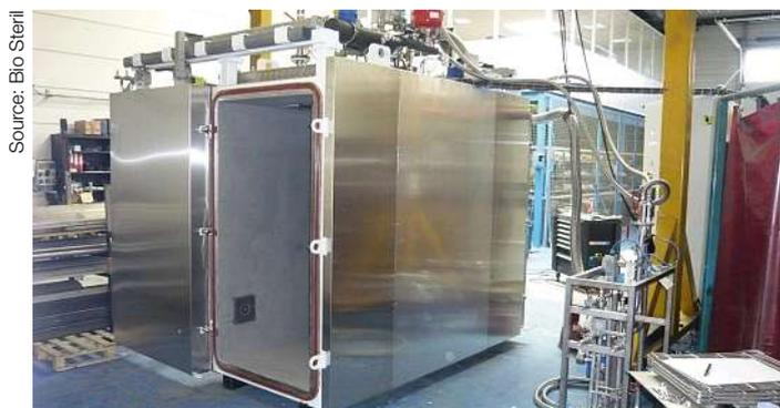
Bio-Stéril a misé sur la sécurité de son installation et sur la traçabilité des paramètres, les cycles étant contrôlés par automate programmable.
