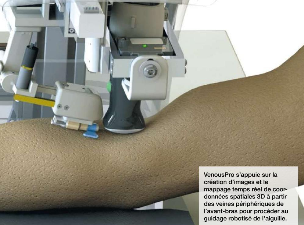
VenousPro s'appuie sur la création d'images et le mappage temps réel de coordonnées spatiales 3D à partir des veines périphériques de l'avant-bras pour procéder au guidage robotisé de l'aiguille.
