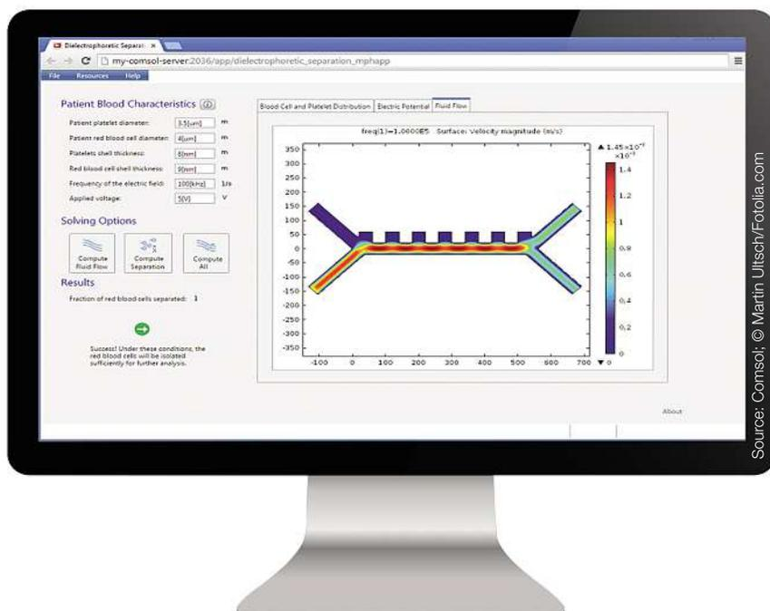
Simulation avec le logiciel Comsol Multiphysics d'un dispositif de séparation d'hématies et de plaquettes, selon leurs caractéristiques, dans un microcanal exposé à un champ électrique alterné.
