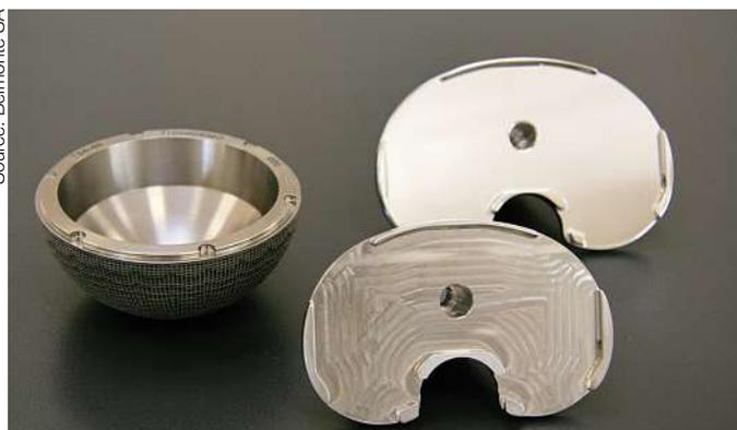
Cotyle en titane usiné à sec et embases Cr-Co fraisées en super finition
