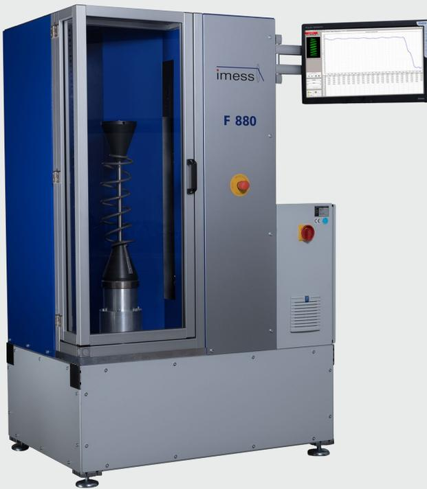
Das System F880 scannt die Fahrwerksfedern und erstellt ein 3D-Modell.
