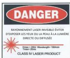
Cette étiquette signale la présence du laser en spécifiant la classe à laquelle il appartient et la puissance de la machine utilisée
