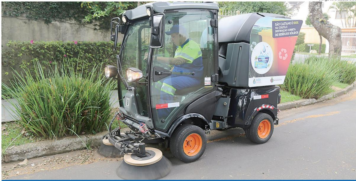
A máquina de varrição mecanizada permite limpeza das sarjetas com alta produtividade
