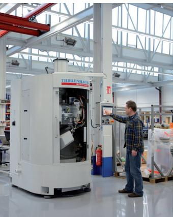
An einer Maschine vom Typ „Sphero“ werden Detailarbeiten für die Feinstbearbeitung von Endoprothesen in der Endausrüstung durchgeführt.
