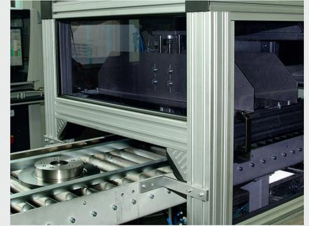
Die Bremsscheiben durchlaufen auf dem Rollenband die Prüfkabine.
