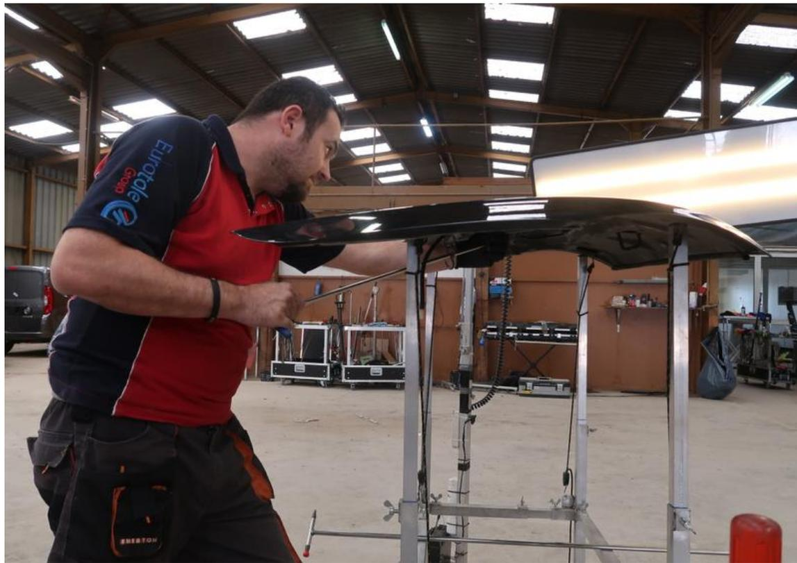
Ce technicien utilise une tige pour redresser la tôle de la voiture endommagée.
