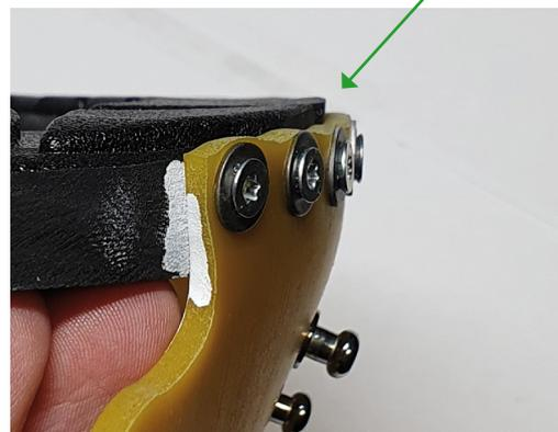
*Im finalen Produkt werden die Seitenlaschen schweißbar werden. Für die Testphase war das nicht möglich & die Schraubverbindung kann bei einem Wechsel der Teile auch hilfreich sein.*
