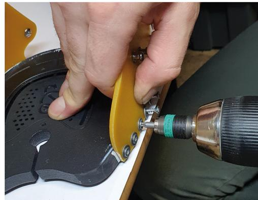
9. Die **Unterkante der Seitenlasche muss unbedingt bündig & auf gleicher Höhe mit dem Profilanfang** verlaufen. Durch die rundliche Form entsteht automatisch eine Winkelung nach innen.
