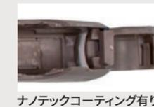
補聴器を過酷な環境にさらす高加速ストレス試験でも、ナノテックコーティング有りの補聴器に損傷は認められませんでした。
