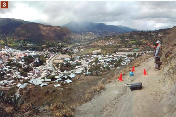
**3.** Barrio Jibaja Ch: Registro de vibración ambiental (H/V) para determinar el periodo de respuesta del suelo y estimar su factor de amplificación ante la ocurrencia sísmica.
