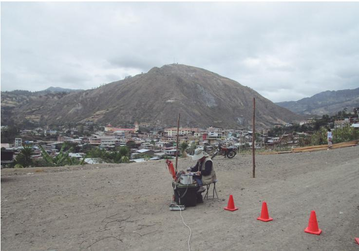
**1.** *Barrios Jibaja Ch. y El Altillo: Registro de datos con el método eléctrico para conocer el contenido de humedad de los suelos.*
