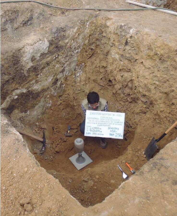
*Ensayos geotécnicos (calicatas): Se realizaron un total de 17 calicatas distribuidas equitativamente en la ciudad de Huancabamba con la finalidad de determinar las características físico-mecánicas de los suelos. Foto: Calicata realizada en las inmediaciones del IESP Jose Eulogio Garrido Espinoza.*
