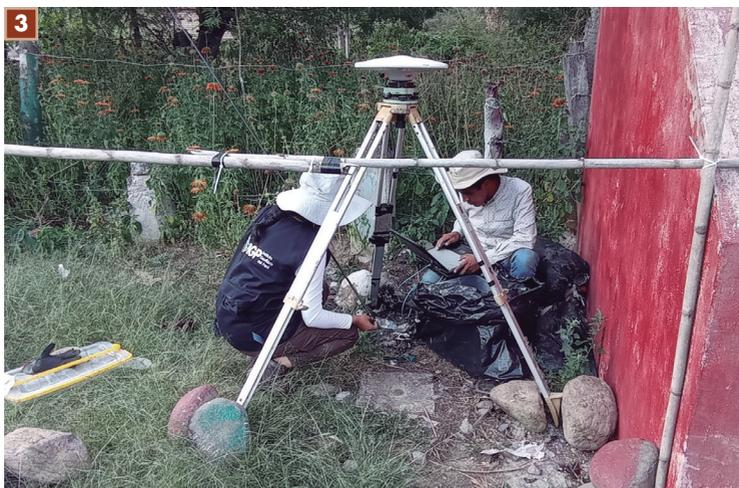
**3.** Configuración de receptor GNSS para el monitoreo geodésico en el centro poblado Jimaca.
