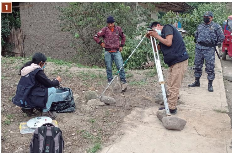
**1.** *Instalación de equipo GPS en el margen izquierdo del río Huancabamba próximo al puente Verde.*
