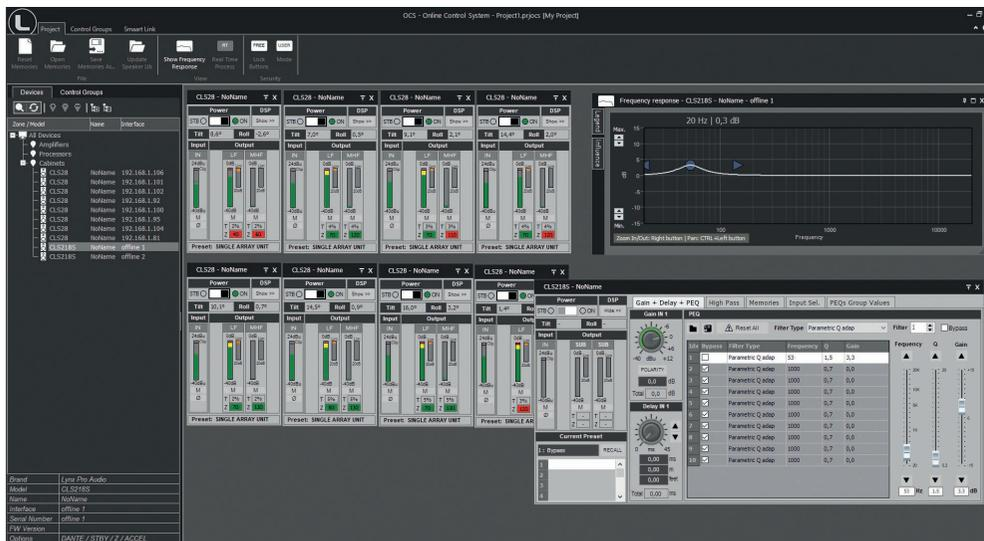
Software de control y monitorización para múltiples dispositivos (altavoces, amplificadores y procesadores). Permite el control a través de Ethernet / USB para los sistemas de Lynx Pro Audio con DSP integrado.
