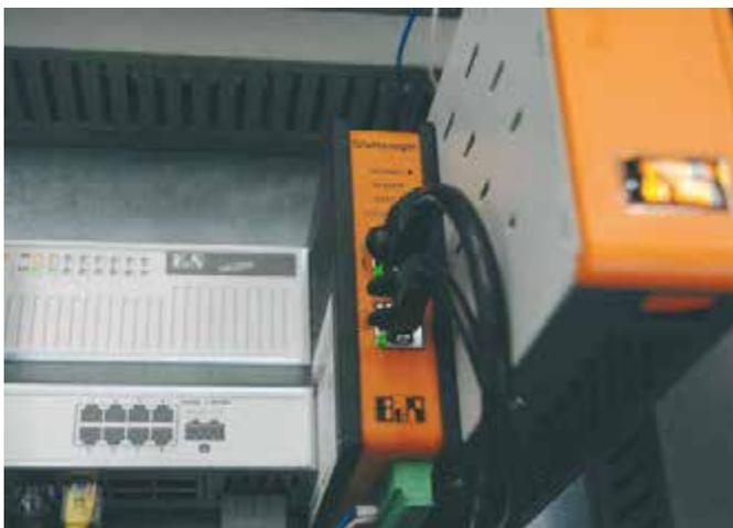
**Die B&R-Fernwartungs-Hardware, der sogenannte SiteManager, muss lediglich an der Maschine platziert werden und baut anschließend den Fernwartungs-Tunnel auf.**
