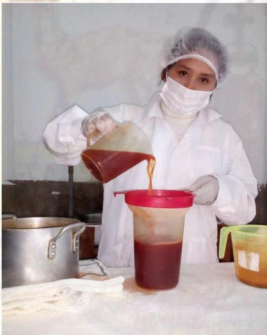
**Imagen N° 15.** Filtrado con colador del baño tintóreo.
