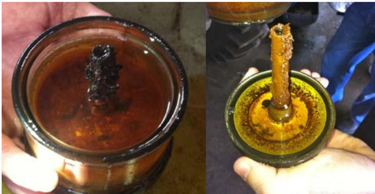
No fundo do tanque, ocorre o acúmulo de água livre juntamente com depósitos de natureza orgânica e inorgânica (borra). A água pode estar presente na forma livre (fundo), ou emulsificada na forma de gotículas dispersas na fase óleo.
