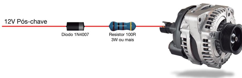
\* O resistor precisa ser colocado em um local que possa dissipar o calor;
