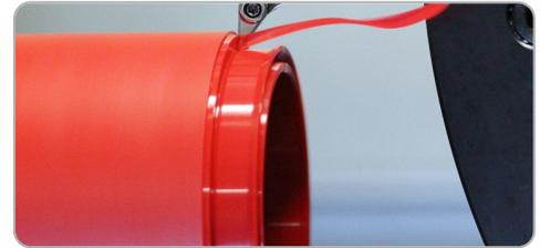
SEALJET Technologie auf Basis der CNC-Drehtechnik (Bild: SKF)
