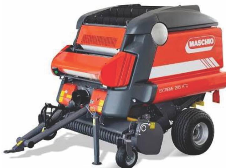
A Extreme 265 HTC exerce uma pressão variável desde o núcleo à camada externa, facilmente definido a partir da unidade de controle existente na cabina do trator. Este sistema de geometria variável permite alterar a pressão exercida durante a formação do fardo e podem ser produzidos fardos pesados mesmo com produtos muito secos.
