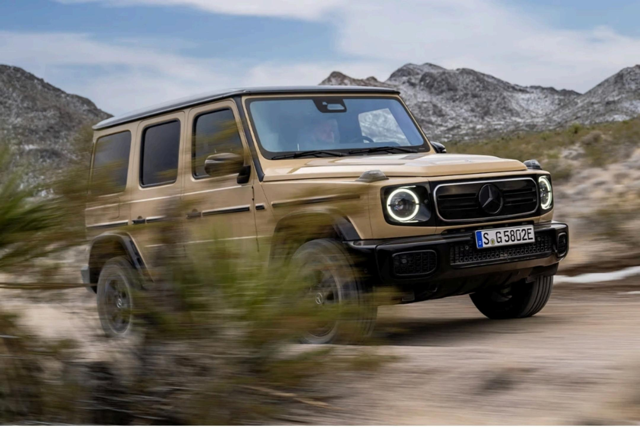
**G 580** 外观设计保留了车系传统的方正轮廓，并将进气格栅替换为具有散热和优化空气动力学表现的黑色面板（可选）。最后，续航性能方面，根据**WLTP**标准，其**116kWh**的锂离子电池组每次充电可行驶**293英里**。
