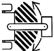
Não transite em rodovias ou estradas pavimentadas. Nas curvas fechadas, evite que as rodas do trator toquem o cabeçalho.
