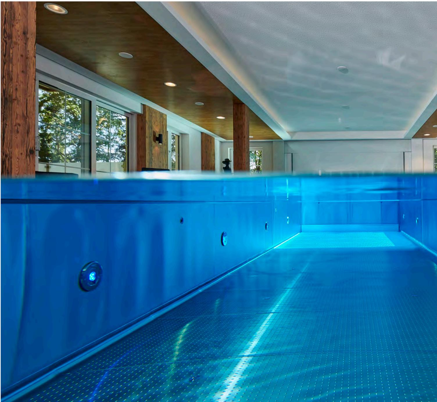
Wie bei Edelstahlbecken üblich, sind die Einströmdüsen im Beckenboden eingebaut. So wird eine gute Vertikaldurchströmung bei dem gewaltigen Wasservolumen erzeugt.
