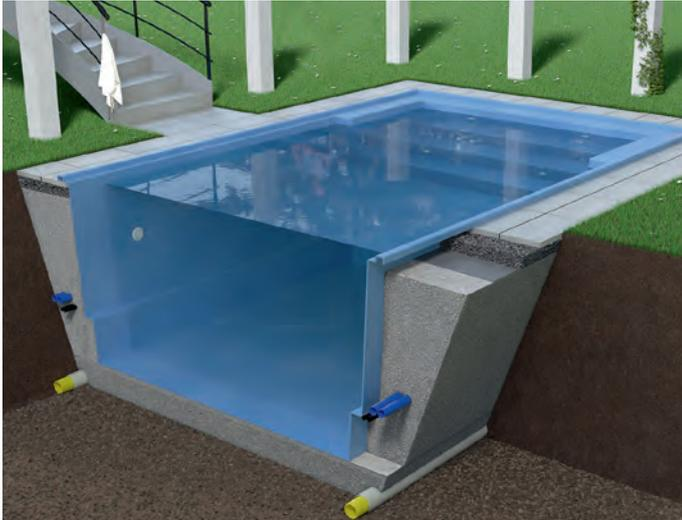
Eine wärmedämmende Unter- und Hinterfüllung von Außenpools ist energetisch nicht mehr wegzudenken. Gängige Materialien für die Bodenplatte und seitliche Hinterfüllung von Außenpools sind Styroporleichtbeton sowie Magerbeton.
