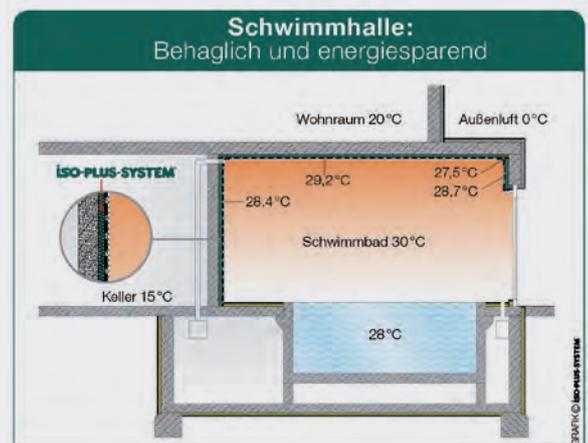
Mit Innendämmung sind die Oberflächen auch in den Raumecken angenehm warm. Wärmebrücken werden sicher überdeckt.
